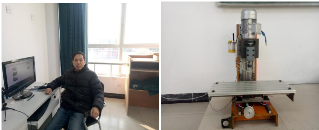
图 16 徐家忠老师和菅风华制作的三轴数控铣床
