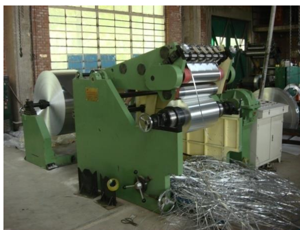
图 31 李慎安教授设计的“850mm 单轴分切机收卷轴”
